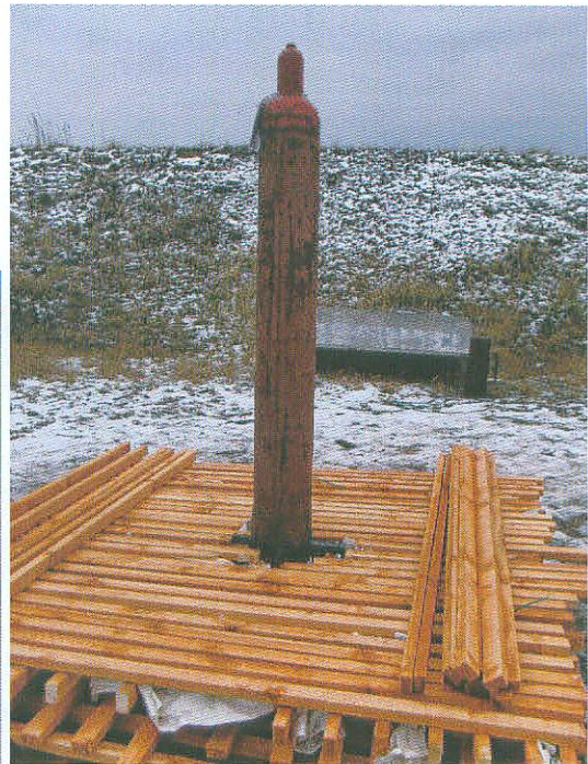
Abb. 2: Gestell im Holzstapel zur Unterfeuerung von liegenden Druckgasbehältern (linkes Bild) und Gestell für die Fixierung stehender Behälter (rechtes Bild)
