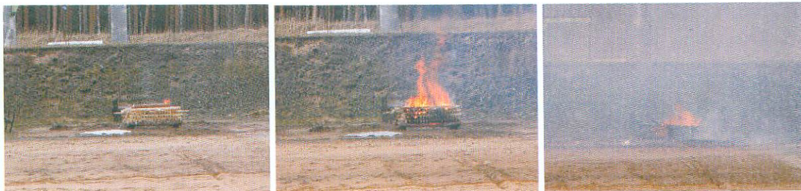
Abb. 19: Bildsequenz einer Unterfeuerung einer leeren, liegenden Acetylenflasche
