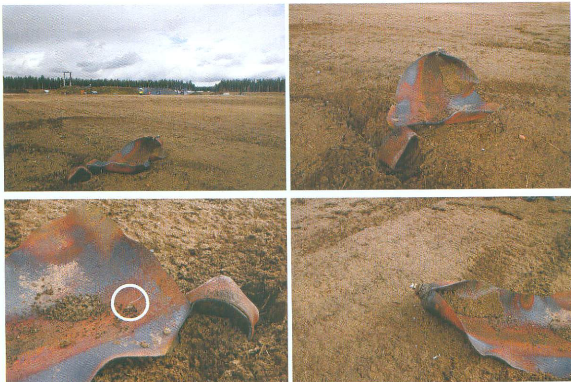
Abb. 21: Geborstene Acetylenflasche nach der Unterfeuerung
