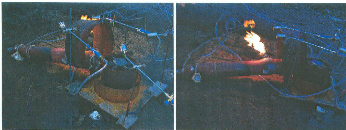
Abb. 12: Aufgerissene Acetylenflasche nach der Befeuerung mit Hilfe von Gasbrennern
