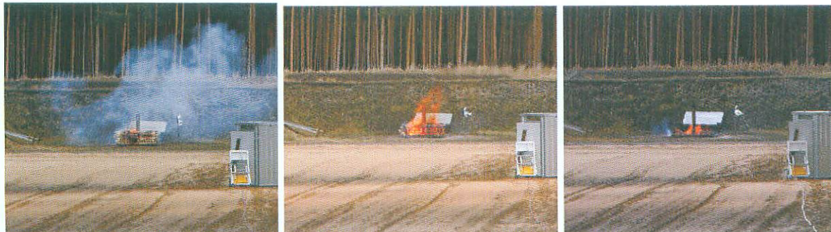
Abb. 17: Bildsequenz einer Unterfeuerung einer leeren Acetylenflasche
