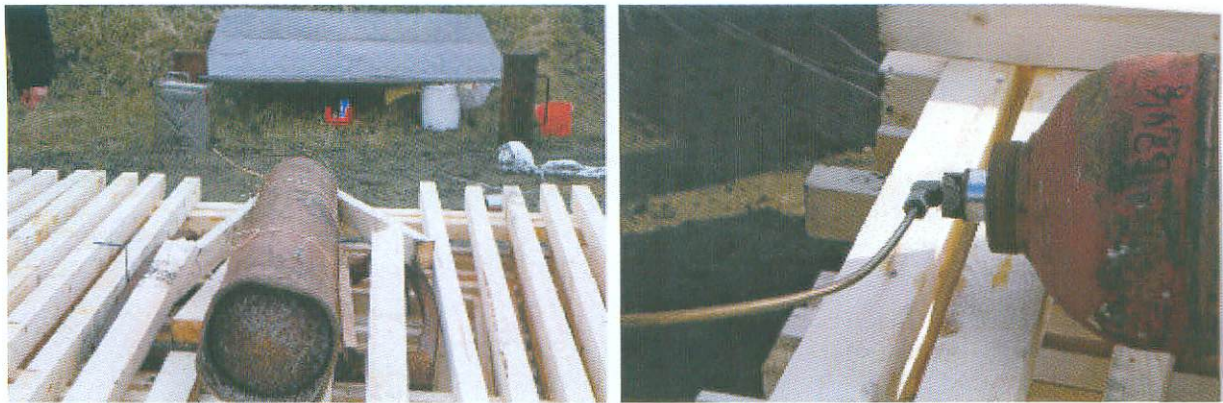
Abb. 6: Fixierung der Thermoelemente zur Messung der Manteltemperaturen und modifiziertes Behälterventil zur Druckmessung
