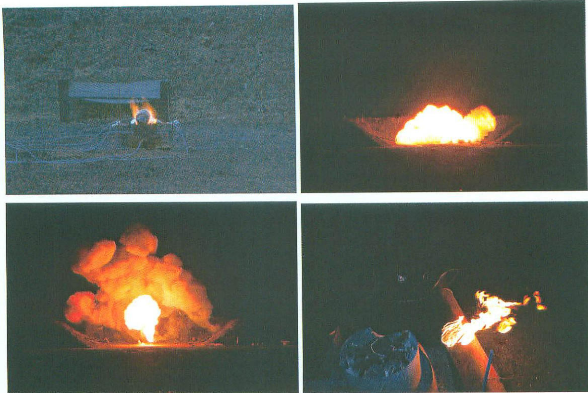
Abb. 15: Bildsequenz der Befeuerung einer liegenden Acetylenflasche mit Hilfe von Gasbrennern (Bild oben links nachbearbeitet)
