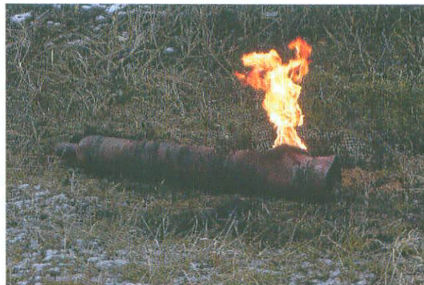
Abb. 8: Bildsequenz der Unterfeuerung einer vollen Acetylenflasche im Holzstapel
