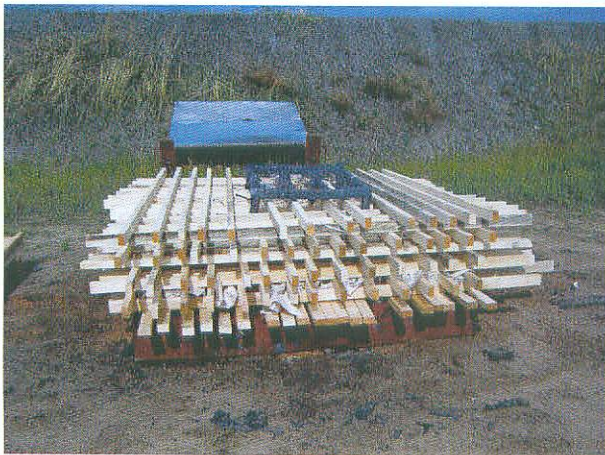
Abb. 2: Gestell im Holzstapel zur Unterfeuerung von liegenden Druckgasbehältern (linkes Bild) und Gestell für die Fixierung stehender Behälter (rechtes Bild)
